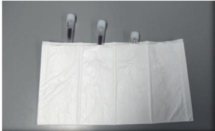
5. Legen Sie die geschlossene Microvette® in die vorgesehene Saugliestasche. Diese verfügen über vier einzelne Fächer, so dass Sie mindestens 4 Proben mit einer Sendung verschicken können.
